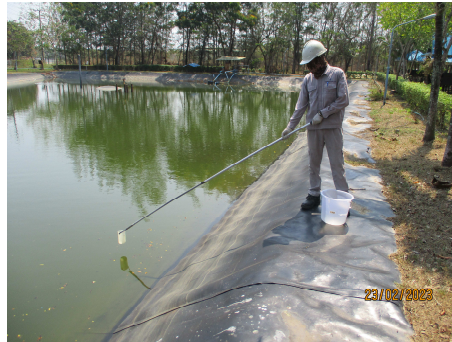
ภาพที่ 3.2.11-1 แสดงการเก็บตัวอย่างน้ำทั้งในบ่อพักน้ำ 3,000 ลูกบาศก์เมตร ของ Pickling Oil Plant (PO Pond)
